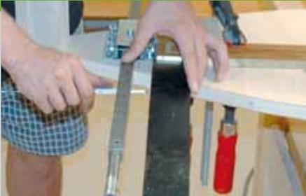
4. Um die Hinterachse im rechten Winkel zur Fahrzeugmittellinie auszurichten, verwenden Sie am besten einen Winkel. Mit einem Messschieber wird der Abstand zwischen Achse und Winkel gemessen und die Achsen so lange verschoben, bis Achsen und Winkel parallel zueinander verlaufen. Verfahren Sie auf die gleiche Art, um an der Vorderachse den Lenkeinschlag einzustellen. Wenn alle Teile im Inneren befestigt und
