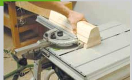
Damit die Spanten an der Kontur der Bodenplatte bündig eingeschraubt werden können, muss auf der Innenseite eine 3 mm breite Aussparung mit der Tischkreissäge eingeschnitten werden. Die Höhe der Aussparung entspricht der Bodenplattendicke. Durch diesen Ausschnitt werden die Kräfte von oben besser auf die Bodenplatte übertragen.
