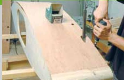
ausgerichtet sind, werden die Seitenteile befestigt. Vorher zeichnen Sie noch die Positionen der Durchgangslöcher für Achsen und Lenkung auf den Seitenteilen an und bohren die Löcher mit einem 35 mm Forstnerbohrer. Für die Befestigung der Seitenteile legen Sie die Kiste auf die Seite und geben Montagekleber (PU-Kleber) auf die Kontaktstellen. Legen Sie nun die erste Sperrholzplatte auf und verschrauben
