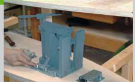
werden, in die Bodenplatte. Die Einzelteile werden nach und nach an den entsprechenden Positionen festgeschraubt. Dazu werden die Schrauben von außen mit einer Karosseriescheibe in die Bodenplatte geschraubt und innen mittels Federring und Mutter gesichert. Ziehen Sie die Schrauben so fest, dass die Karosseriescheibe unten ins Holz gedrückt wird.
