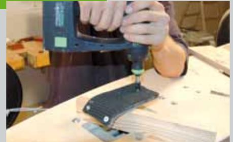
in zwei Schichten der Decklack aufgetragen werden kann. Nach dem Lackieren polstern Sie das Einstiegsloch rundherum mit Schaumstoff. Zuletzt wird der Bremsbelag von unten auf den Bremsschuh aufgeschraubt. Bitte beachten Sie hier, dass die Schrauben so tief eingedreht werden, dass sie nicht auf dem Asphalt schleifen.
