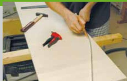
Die aufgezeichneten Punkte verbinden Sie mit einer biegsamen Leiste. Um die Aussparung für die Bremse in der Bodenplatte auszuschneiden, bohren Sie zuerst jeweils ein Loch in die Eckpunkte der Aussparung ( $d=10\text{ mm}$ ). Diese Löcher helfen beim anschließenden Ausschneiden der Aussparung mit der Stichsäge. Neben der Aussparung für die Bremse schneiden Sie auch noch die Aussparungen für die Spanten (Pos. 28)
