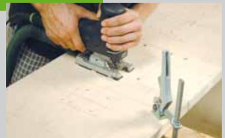
und die Außenkontur der Bodenplatte aus. Da die Außenkontur nur eine leichte Rundung aufweist, kann zum Schneiden ein Sägeblatt für gerade Schnitte verwendet werden. Besonders exakte und ausrissfreie Schnitte erreichen Sie mit Sägeblättern ohne Schrängung, da diese am hinteren Ende dünner geschliffen sind und so ein Verkleben verhindern.
