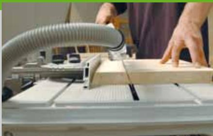
2. Die Leisten für Front- und Heckaussteifung (Pos. 22 und 24) werden auf der Tischkreissäge schräg geschnitten. Die Frontaussteifung besteht aus 5 Streifen Stabplatte oder Massivholz. Die Streifen werden miteinander verleimt und dann mit einem Handhobel gerundet. Der hintere Streifen bildet automatisch auf jeder Seite einen so genannten Falz, in den später die Sperrholzplatte eingelegt
