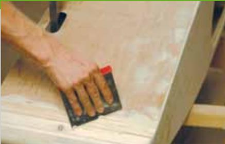
5. Die Kanten runden Sie mit einem Handschleifklotz oder einer Kantenfräse. Zuletzt werden die Flächen mit einem Exzenterschleifer und Schleifpapier Körnung P 120 geschliffen. Anschließend werden alle Schraubenlöcher, Spalten und Unebenheiten mit Autospachtel (Polyesterspachtel) gespachtelt. Nach dem Aushärten wird der erste Spachtelauftrag geschliffen und in einem zweiten
