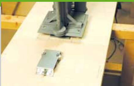
1. Zeichnen Sie auf der Bodenplatte (Pos. 21) in Längsrichtung eine Mittellinie ein. An dieser Linie werden die in der Zeichnung angegebenen Positionen des Fahrwerks und der Lenkung angezeichnet. Um die Rundung der Karosserie anzuzeichnen, müssen Sie die in der Zeichnung angegebenen Punkte übertragen. Berücksichtigen Sie dabei, dass die Grundplatte um die Dicke der Seitenteile (Pos. 26) verkleinert werden muss.
